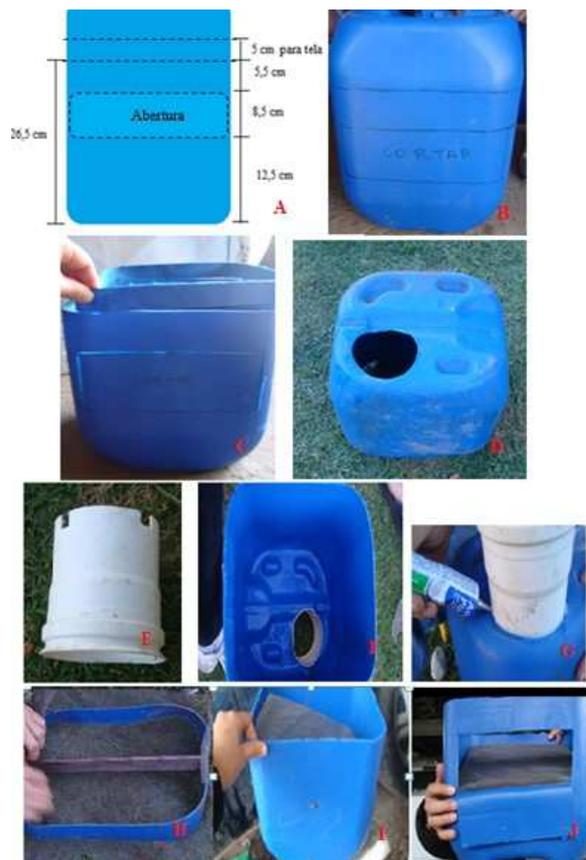
Fig. 3: Montagem do Filtro captador de água
