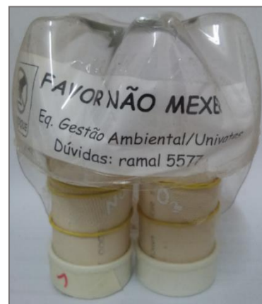
Fig.3: Amostradores passivo de baixo custo com proteção para dias chuvosos
