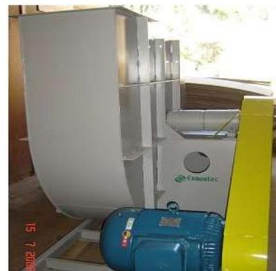
Figura 10: Exaustor centrífugo motor de 45 kW (VENTO675).
