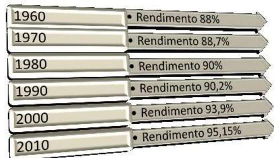
Figura 04: Evolução do rendimento dos motores elétricos de indução.
