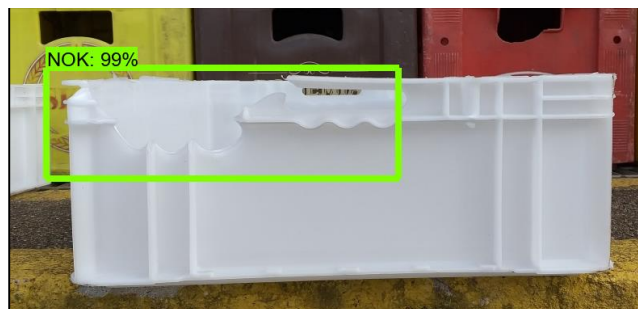
Figura 11 – Exemplo de detecção de falha.
