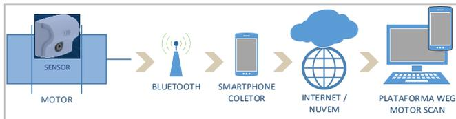
Figura 8: Esquema do sistema de coleta e análise dos dados
