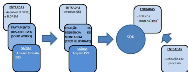
Figura 5 - Coleta de dados e preparação para inclusão no SDK
