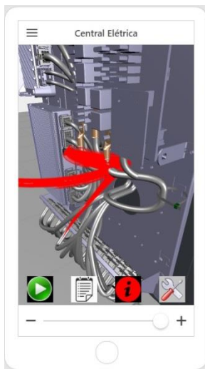
Figura 9 - Interferência entre elementos 3D
