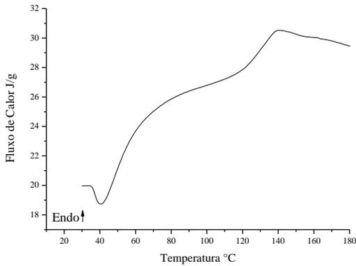
Fig. 10: Gráfico de análise DSC da amostra C.
