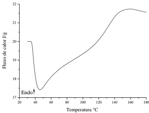
Fig. 9: Gráfico de análise DSC da amostra B.
