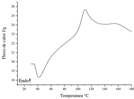
Fig. 8: Gráfico de análise DSC da amostra A.
