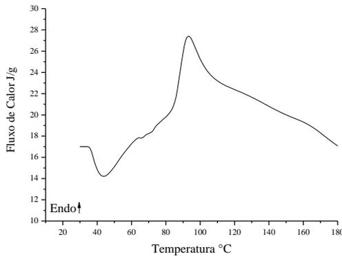
Fig. 18: Gráfico de análise DSC da amostra H.
