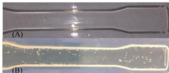
Fig. 7: Corpo de prova D antes e depois do ciclo de cura.
