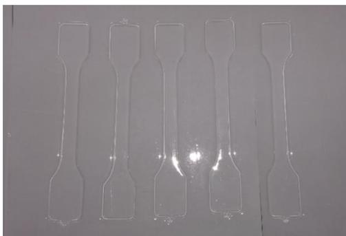
Fig. 4: Matriz dos corpos de prova.
