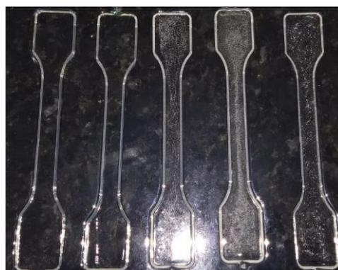
Fig. 3: Processo de extração das bolhas das amostras.
