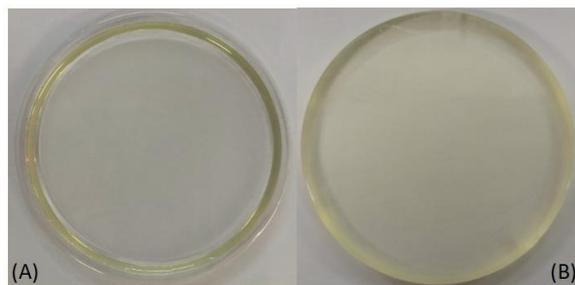
Fig. 13: Resina epóxi após o processo de cura.
