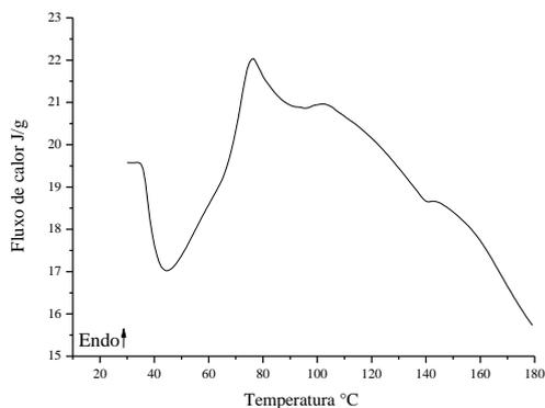
Fig. 14: Gráfico de análise DSC da amostra F.
