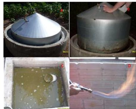
Fig. 2 – (A) Biodigestor, (B) movimentação do gasômetro, (C) biofertilizante e (D) queima biogás.
