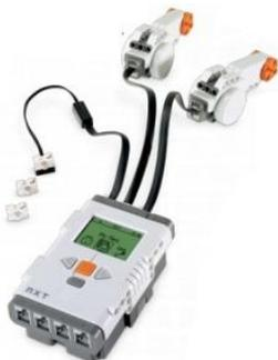
Fig. 3: Controlador com conexão dos motores e lâmpadas e cabo USB
