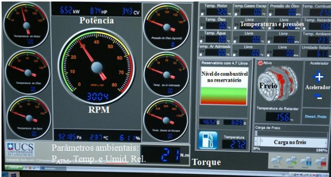
Fig. 2: Supervisor de comando e coleta de dados do dinamômetro
