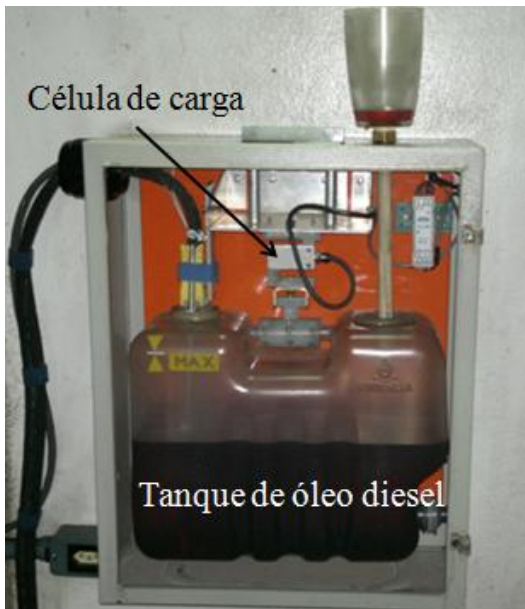
Fig. 3: Sistema de medição do consumo de OD
