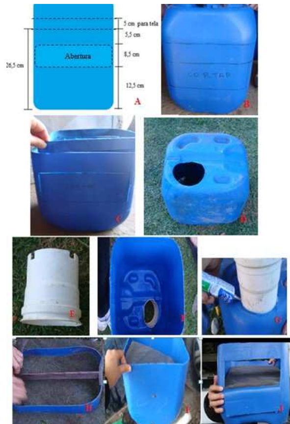
Fig. 3: Montagem do Filtro captador de água
