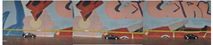
Fig. 3: Sequência de fotos do grupo 6 utilizando carrinho de fricção. Foram obtidos 5 instantâneos com intervalo de tempo médio de 0,25s.
