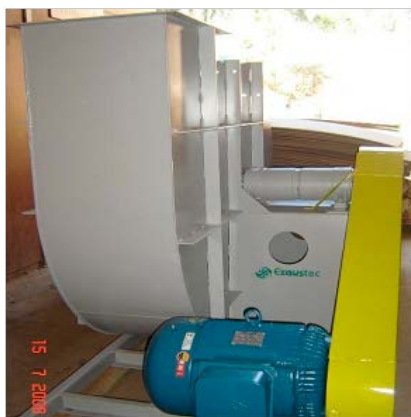
Figura 10: Exaustor centrífugo motor de 45 kW (VENTO675).
