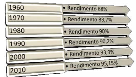
Figura 04: Evolução do rendimento dos motores elétricos de indução. Fonte: WEG
