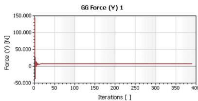
Figura 04: Gráfico da força de sustentação da asa finita a 2°.
