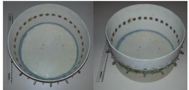
Figura 6: Phantom com 16 eletrodos
