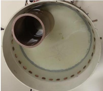
**Figura 8: Cano de PVC inserido no phantom**
