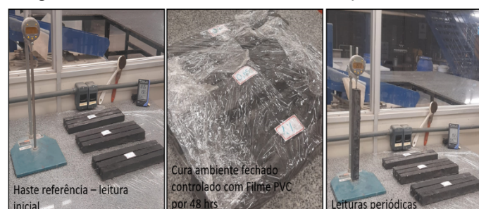
Figura 2 – Procedimento do ensaio de variação dimensional
