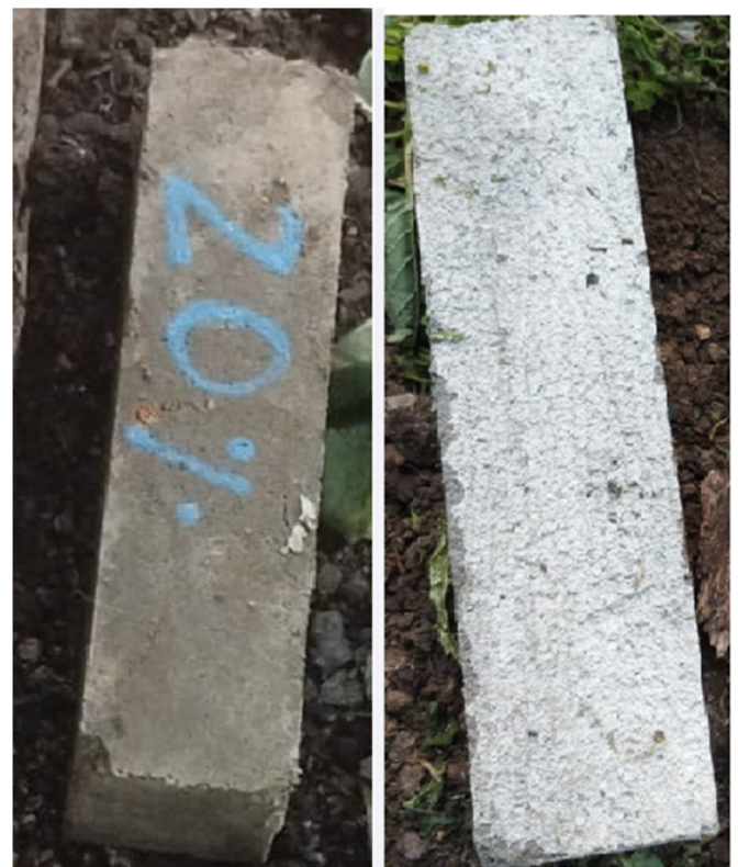
Figura 8. Deficiência no tempo de cura dos corpos de prova com 20% de ZnO.
