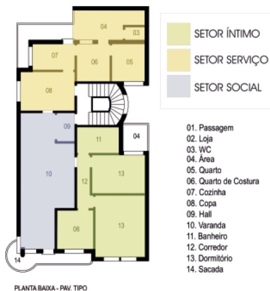
Figura 34: Planta Baixa do Ed. Caberlon – estar/jantar integrados
